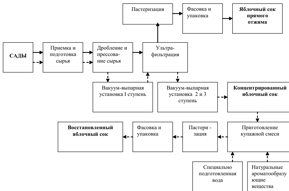
Рис. 3. Схема технологического процесса производства соков как основа организации системы учетно-контрольного управления сегментами деятельности
