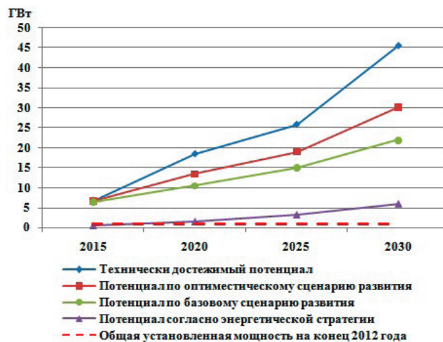
Рис. 2. Установленная мощность электростанций на возобновляемых источниках энергии к 2030 году
