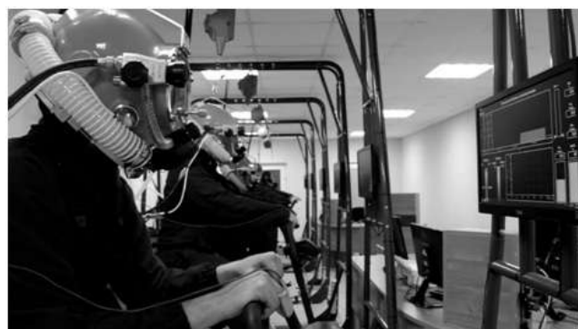
Рис. 2. Учебное место водолаза на тренажерном комплексе «КСТ»
