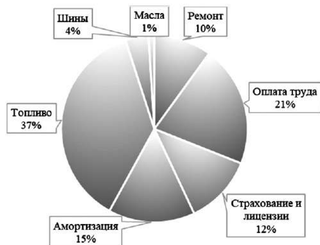
Рис. 4. Структура затрат перевозчика (рассчитано для среднего грузовика, 38 т с трехосным прицепом, со средним пробегом 100 000 км/г) (сост. по: Экономия топлива // ThePresentation.ru. URL: https://thepresentation.ru/uncategorized/ekonomiya-topliva )
