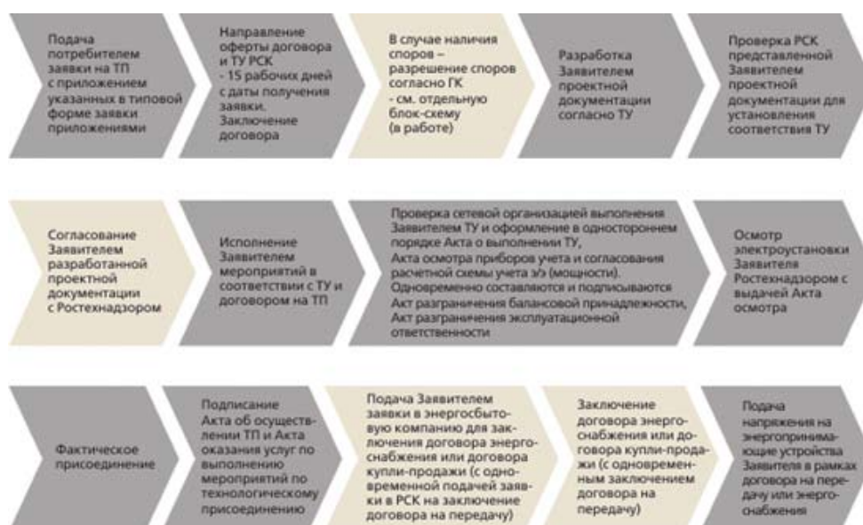
Рис. 1. Пример функционального построения процесса в энергокомпаниях на основе схемы присоединения к электрическим сетям
