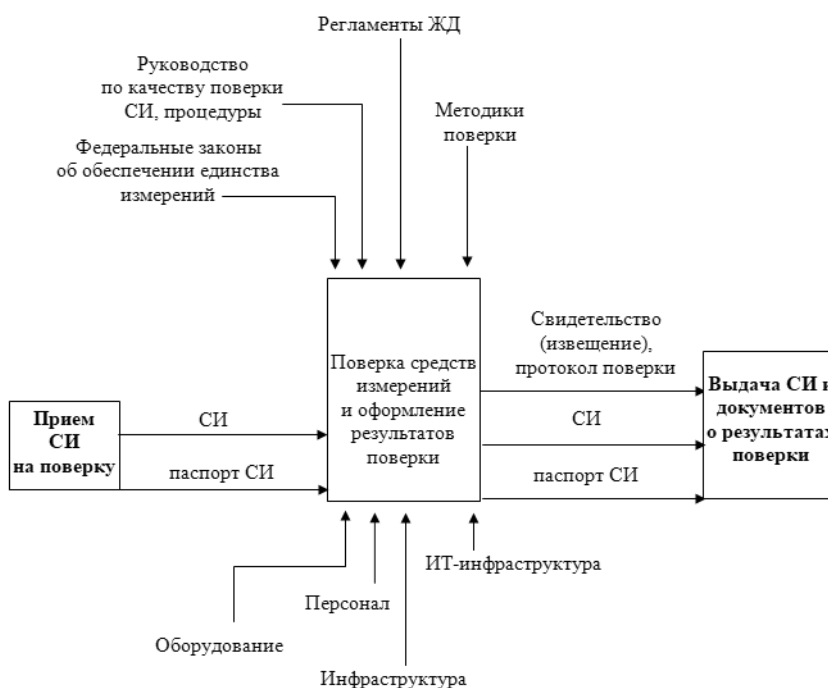
Рис. 2. Модель процесса «Поверка средств измерений»
