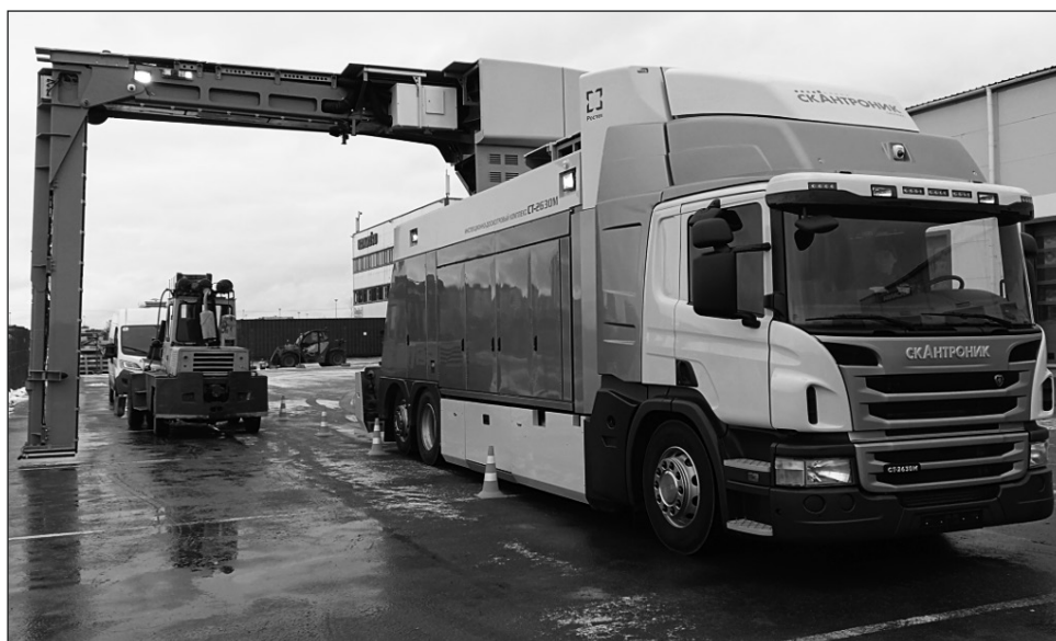
Рис. 1. ИДК мобильного типа российского производства СТ-2630М
