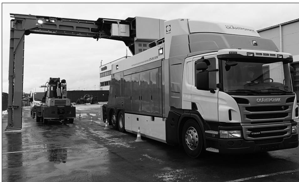
Рис. 1. ИДК мобильного типа российского производства СТ-2630М
