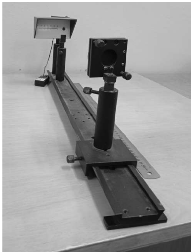
Рис. 1. Лабораторная установка для наблюдения колец Ньютона
