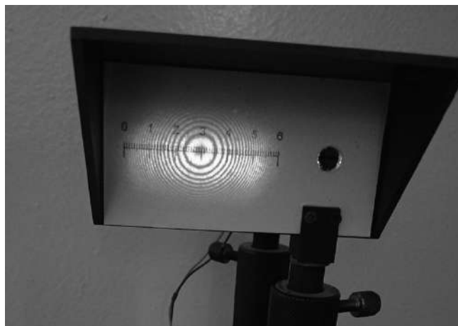
Рис. 3. Наблюдение колец Ньютона
