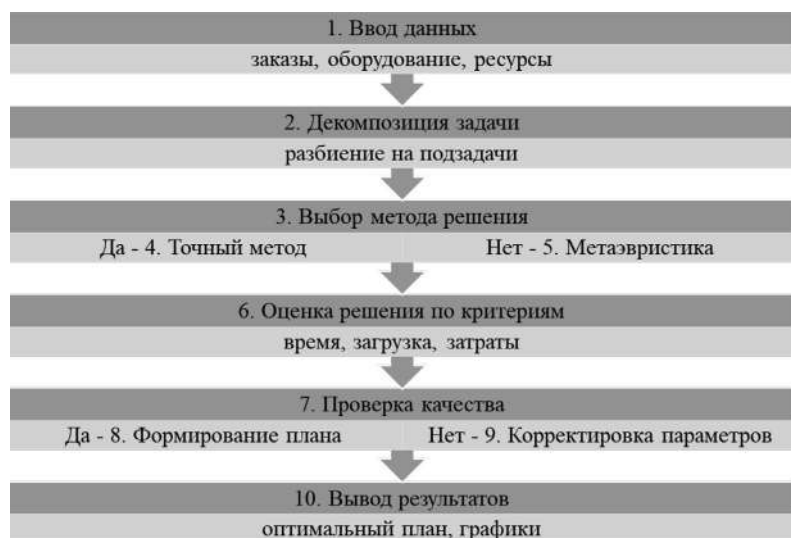
Рис. Блок-схема гибридного алгоритма оптимизации производственных процессов (сост. автором)
