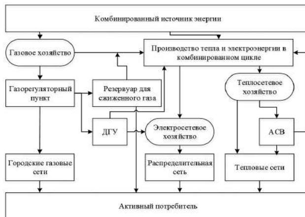
Рис. 1. Модель интегрированной энергосистемы на базе комбинированного источника энергии (составлено автором)
